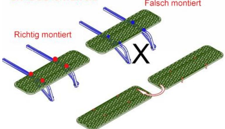
B.) Schritt 2, Bitte verwenden Sie Teil K auf dem Schritt 1 durch 4pcs Schrauben #3, dann mischen Sie Teil S durch3pcs Schrauben #3
