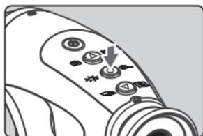
4 IR Modi stehen zur Verfügung: geringe Intensität, mittlere Intensität, hohe Intensität sowie IR ausgeschaltet.
