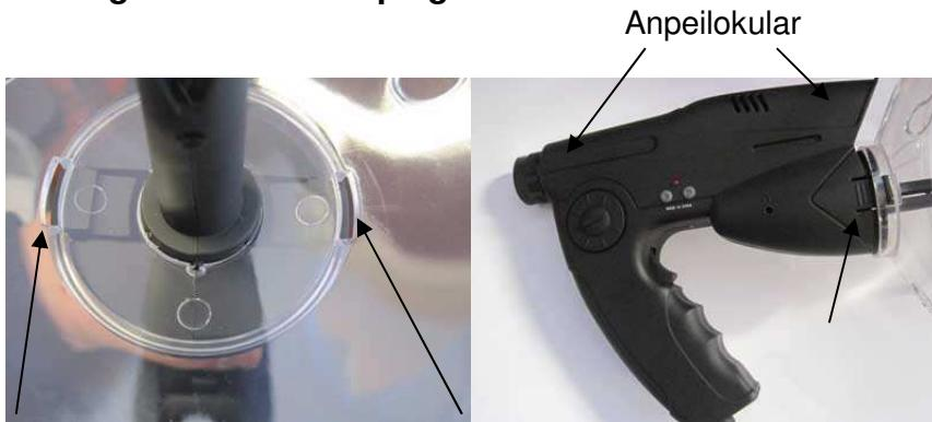
Drücken Sie die beiden Halteknebel für den Parabolspiegel zum Gerät nach innen um den Parabolspiegel einzurasten zu lassen. Achten Sie hierbei darauf, das sich das ausgelassene Guckloch im Parabolspiegel in Höhe des Anpeilokulars befindet.
