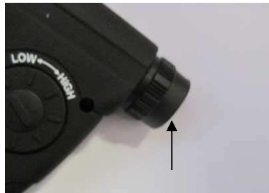
Das Gerät wurde mit einer optischen Anpeilhilfe ausgestattet, in dessen Okular eine Linse mit 8facher Vergrößerung eingebaut wurde. Um das Okular scharf zu stellen fokussieren Sie das Objekt und drehen Sie an dem Einstellring (siehe Pfeil) bis Sie es scharf“ sehen können. Vorsicht!
