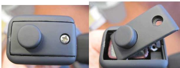
Lösen Sie die Sicherungsschraube am Batteriefachdeckel und nehmen diesen ab. Durch vorsichtiges Drehen können Sie den Deckel aus der Führungsschiene nehmen. Schließen Sie nun eine 9V Blockbatterie an und beachten Sie die +/- Polung der Anschlüsse. Nachdem Sie die Batterie eingelegt haben schließen Sie das Batteriefach und fixieren es mit der Sicherungsschraube.
