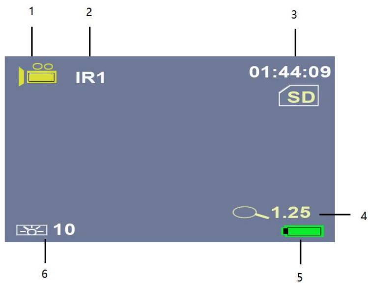
Informationen zur LCD-Anzeige. Drücken Sie [MODE] viermal hintereinander und rufen Sie den Menümodus auf. Hinweis: [IR] bedeutet „oben“. [ZOOM] bedeutet „nach unten“. [SNAP] bedeutet „OK“-Taste. Nach der Einstellung können Sie erneut [MODE] drücken, um das Menü zu verlassen.
