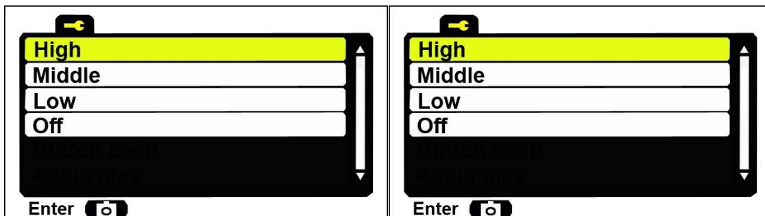
Flackern Sie können mit [IR] und [ZOOM] zwischen 50 Hz und 60 Hz wählen. Drücken Sie abschließend zur Bestätigung [SNAP].
